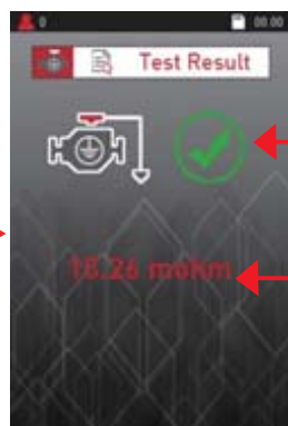
Le résultat du test indiquant que la connexion à la terre est bonne.
