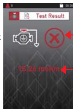
Résultat du test indiquant que la connexion à la terre n'est pas bonne.
